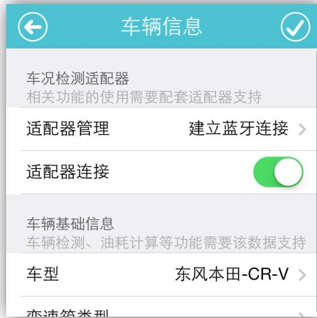
连接车辆时请开启手机蓝牙；如未绑定适配器，软件将每次连接都搜索周边可用适配器，为了能快速连接适配器，建议连接前进行适配器绑定。
